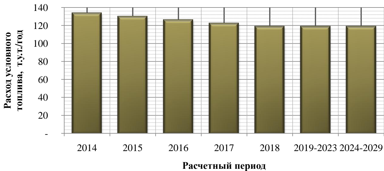
Рисунок 13. Годовой расход условного топлива для котельной №6
