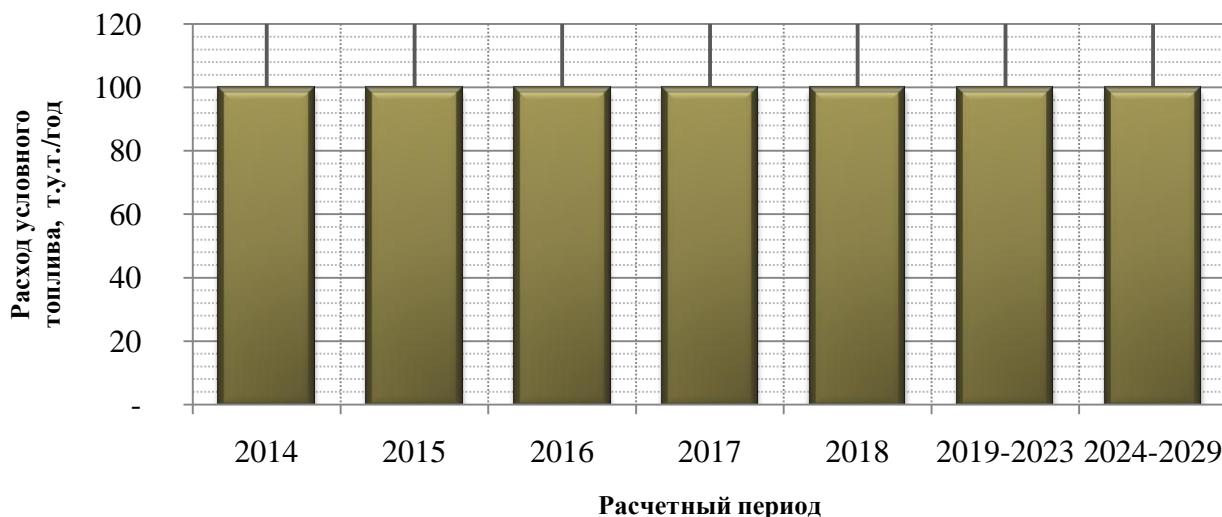
Рисунок 15. Годовой расход условного топлива для котельной (ул.Садовая)
