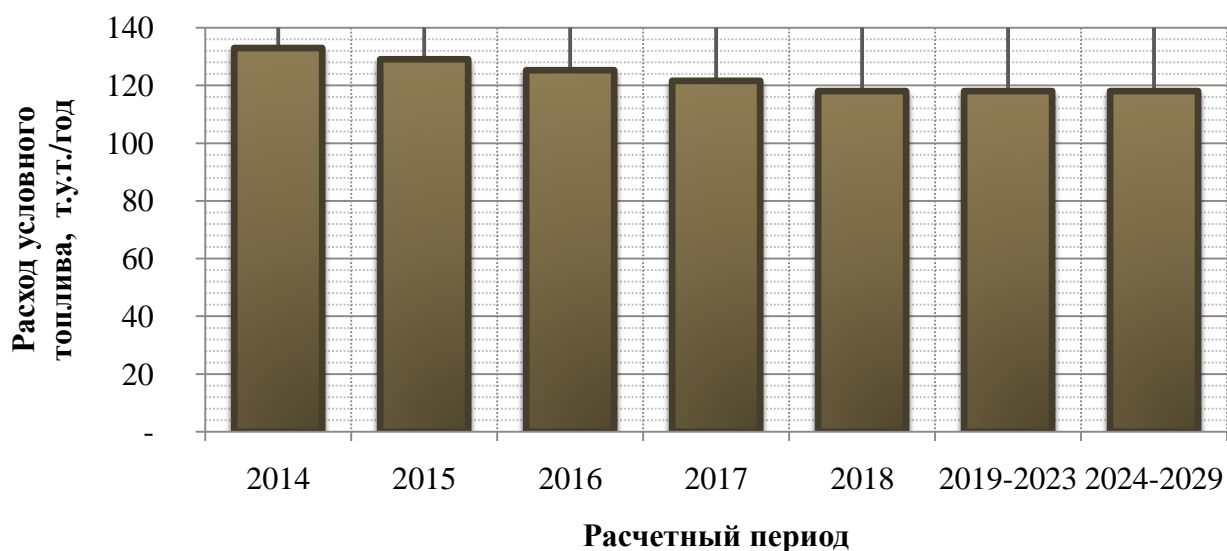
Рисунок 8.3. Годовой расход условного топлива для котельной №6
