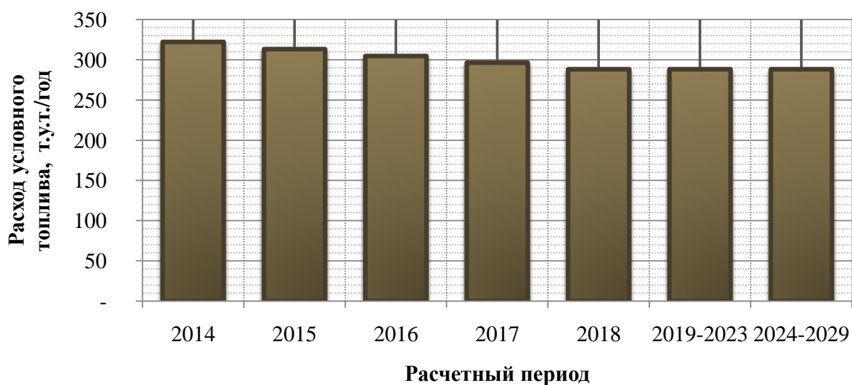
Рисунок 8.2. Годовой расход условного топлива для котельной №5
