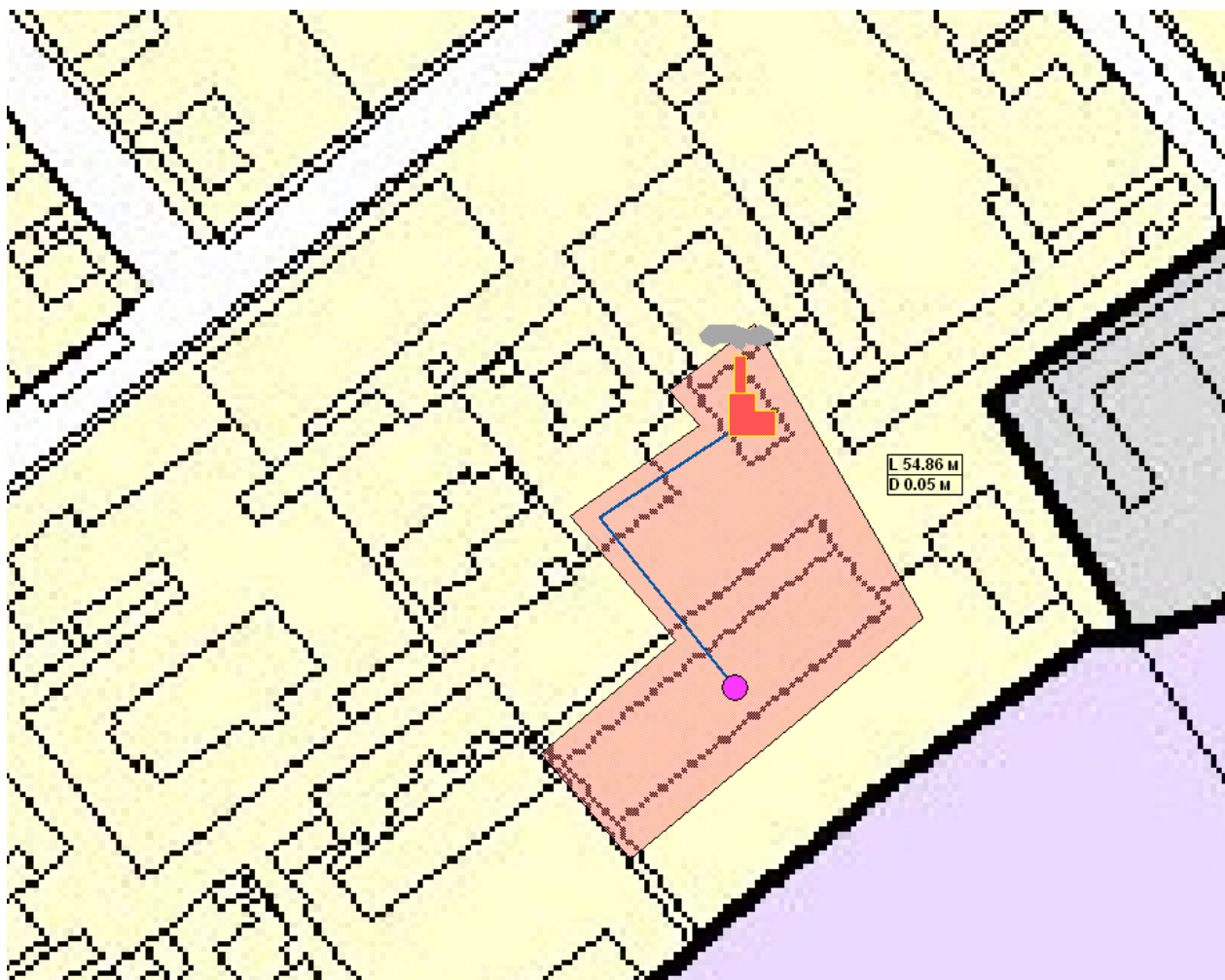
Рисунок 1.13. Зона действия котельной (ул. Садовая)
